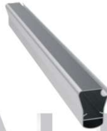
Eko İnce Korniş Ürün Kodu: 37156 Ağırlık kg/m: 0,845 (56 x 43 x 1,4mm)
