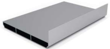
Alt Baza Profili Ürün Kodu: 2566 Ağırlık kg/m: 1,423 (35 x 134 x 1,6mm)
