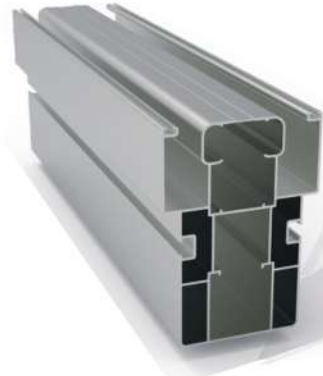
Eko Ray Profili Ürün Kodu: 2785 Ağırlık kg/m: 5,352 (160 x 91 x 1,9 mm)
