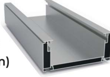
Oluk Profili Ürün Kodu: 2337 Ağırlık kg/m: 4,560 (85 x 205 x 2 mm)
