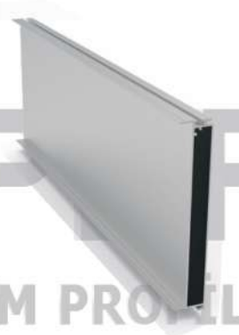
Oluk Ön/Arka Kapama Profili Ürün Kodu: 2338 Ağırlık kg/m: 1,730 (164,5 x 28,5 x 1,6 mm)
