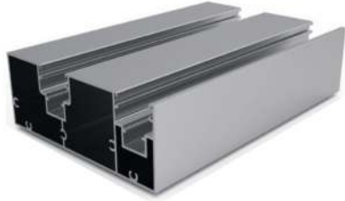
Yan Kasa Profili Ürün Kodu: 2066 Ağırlık kg/m: 2,414 (50 x 131 x 1,5mm)
