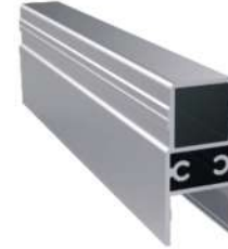
22mm Dikme ve Alt Profili Ürün Kodu: 3064 Ağırlık kg/m: 1,030 (57,5 x 27 x 1,7mm)
