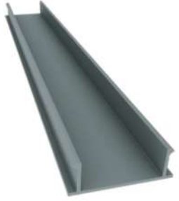
Ray Kapak Profili Ürün Kodu: 37270 Ağırlık kg/m: 0,230 (13 x 39 x 1,3mm)
