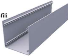
Kış Bahçesi Ayak Profili Ürün Kodu: 2009 Ağırlık kg/m: 3,050 (130 x 124 x 2,4mm)
